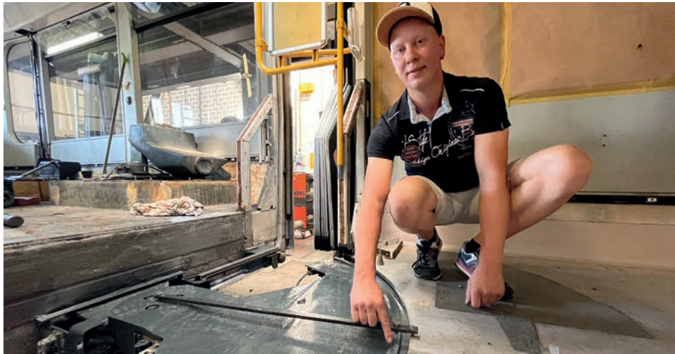
Tilo Ermlich zeigt die Einschweißlehre mit der ein punktgenaues Anschweißen möglich ist.
